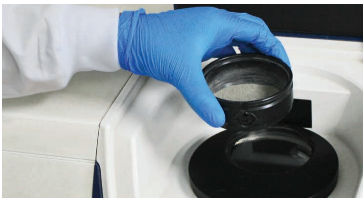
Equipo NIR analizando Materia Orgánica con muestras de suelo. La ilustración demuestra de cómo se desarrolla el análisis.
